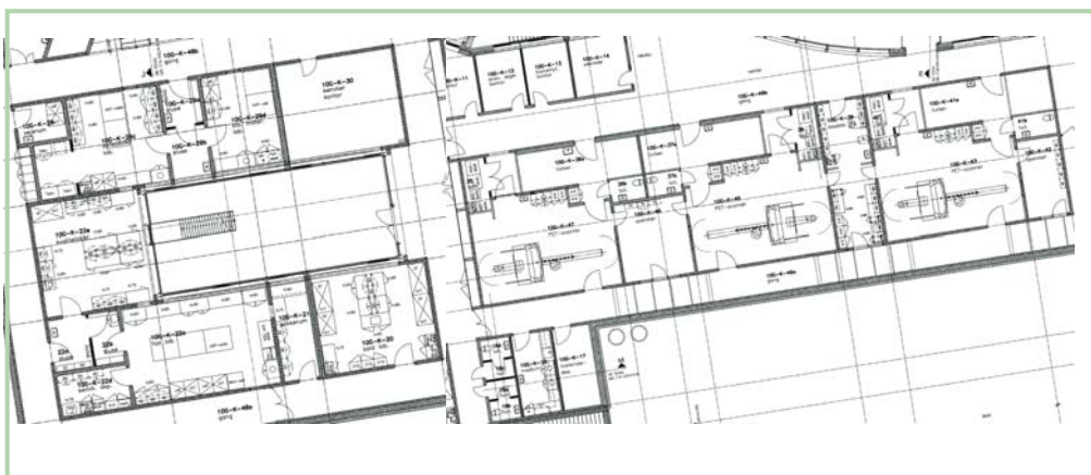
Indretningstegninger for de nye kemilaboratorier (til venstre) og de tre nye skannerrum med tilhørende betjeningsrum og lokaler til patientforberedelse (til højre).
